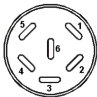
Abb. 24: Pinbelegung der DIN-Buchse (10) für Option Analogausgang
